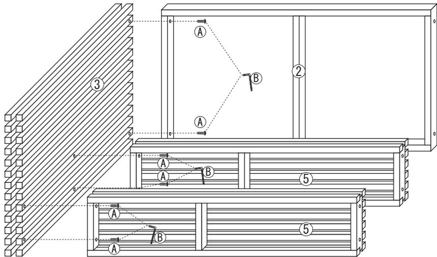
**3** 2で組み立てた商品に、④右足を下記のイラストの様にA六角ボルトと、B六角レンチを使用して止めて下さい。
