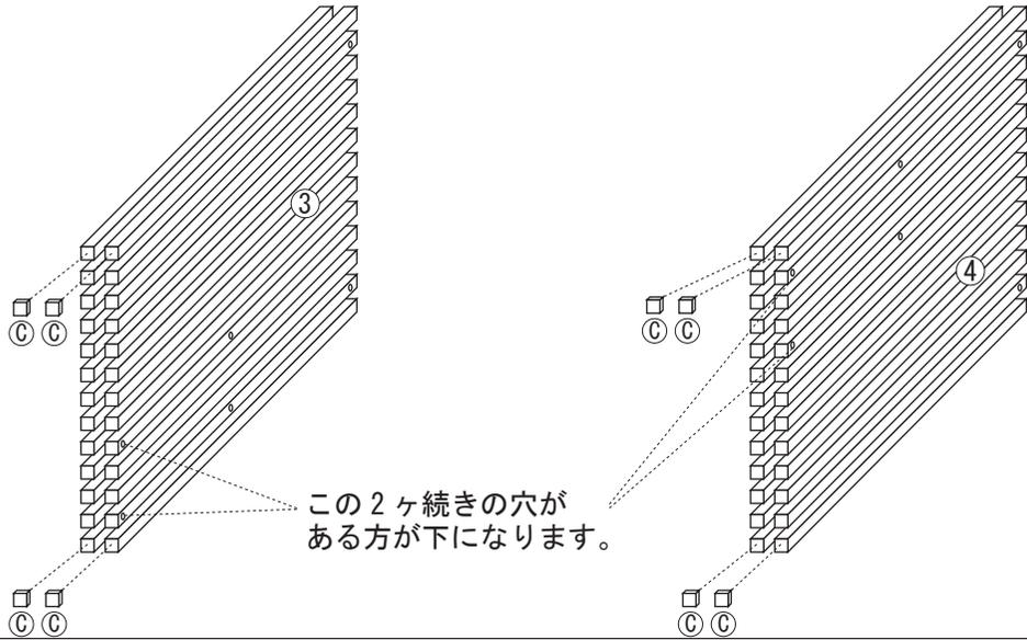
**2** ③左足の上部分の穴に、②天板フレームを下記のイラストの様に、A六角ボルトと、B六角レンチを使用して止めて下さい。
