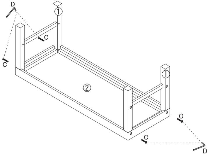
③ ①で組立てた物と、②で組立てた物を下記のイラストの様にAボルト(長)とD六角レンチを使用して組立ててください。
