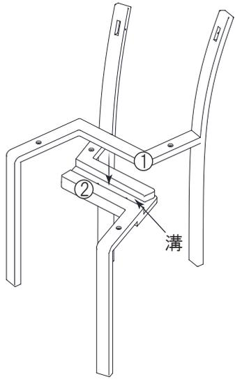
**3** **2** で組立てた部材を下記のイラストの様に、座面の裏の4ヶ所の穴にAボルト、CスプリングワッシャーとDワッシャーをE六角レンチ(大)を使用して組立てください。
