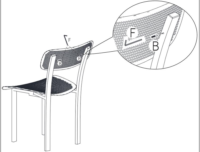
**2** **1** で組立てた部材の裏に①脚1と②脚2の接続処に穴が開いています、下記のイラストの様に、Aボルト、CスプリングワッシャーとDワッシャーをE六角レンチ(大)を使用して組立てください。
