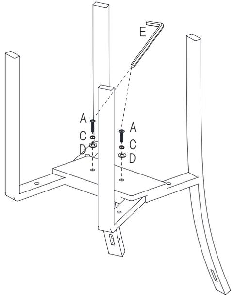
**4** **3** 背板の裏には突出があります、その突出を下記のイラストの様に、**3** で組立てた部材の溝に挿し込んでください。
