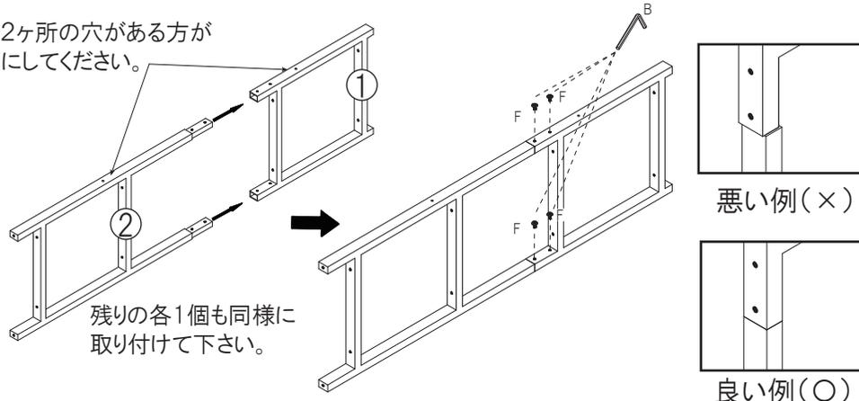
①上フレームと、②下フレームはスムーズに組立ができるように、挿し込み部分にあそびの隙間
