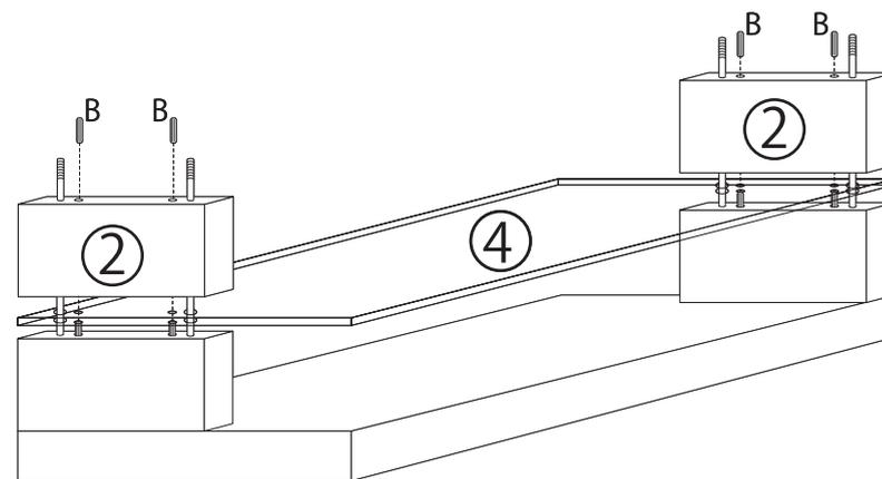
**3** 2で組立てた【ガラス板】の角に合わせて【③支柱板（片面穴）】の角に合わせて置き、ダボ穴に【Bダボ】を挿し込みます。【⑤底板】の表面を床に向けボルト穴・ダボ穴に【③支柱板（片面穴）】に差し込んだ【ダボ】と【支柱板（両面穴）】に挿し込んだ【支柱ボルト】【ダボ】を挿し込みます。
