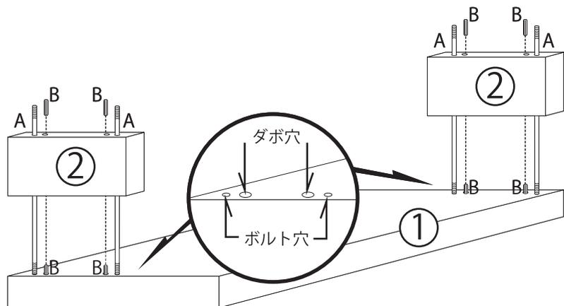
**2** 1で組み立てた【支柱板（両面穴）】の【支柱ボルト】と【ダボ】に【④ガラス板】を挿し込みます。【④ガラス板】の【支柱ボルト】と【ダボ】に【②支柱板（両面穴）】のボルト穴・ダボ穴を合わせて挿し込んで下さい。【②支柱板（両面穴）】のダボ穴に【B ダボ】を挿し込んで下さい。
