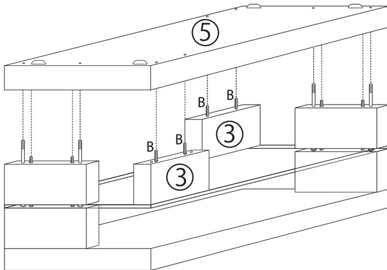
**4** 【底板】の長辺にあるボルト穴に【Cボルト】を挿し込み【F六角レンチ】で締めて下さい。【底板】短辺のボルト穴内の【支柱ボルト】に【Eワッシャー】を挿し込み、その上に【Dナット】を重ねて挿し込んだら【G筒形レンチ】で締めて下さい。
