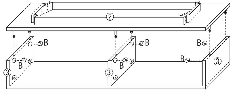
**4** ②底板の裏側に最初から木棧が付いています。その木棧の4隅に2ヶずつ穴が開いているのでその穴と、④脚の穴を合わせて、下記イラストの様に内側からAボルトを通して、B六角レンチで締めて下さい。その後で脚先の4ヶ所に、Cクッションシールを貼り付けて下さい。
