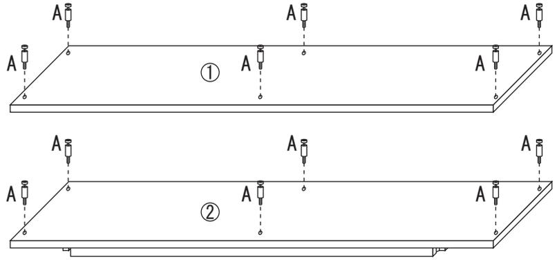
**2** ①で①天板に取付けたAカムロックピンに、下記のイラストの様に③側板を挿し込んで、その後に横からBカムロックを入れて、ドライバーでBカムロックを締めて下さい。
